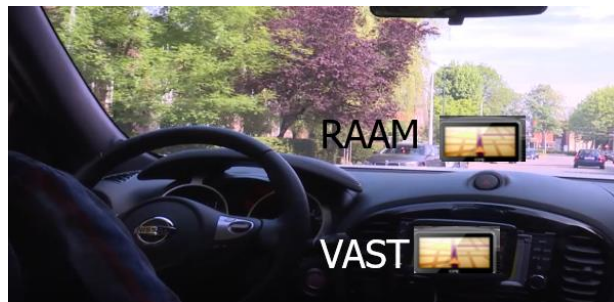
Figuur 6 Afbeelding van de twee opstellingen 'RAAM' en 'VAST' die in de oogbewegingsstudie gebruikt werden.
