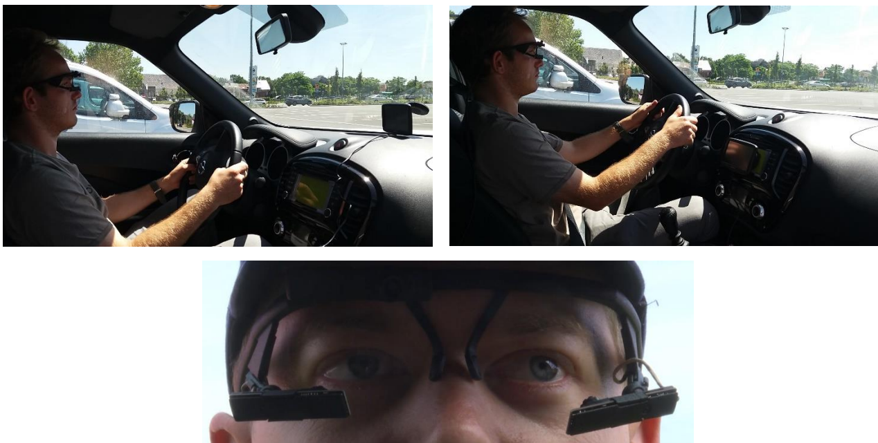
Figuur 7 Links: opstelling met raampositie. Rechts: opstelling met vaste positie. Onder: Oogbewegingsbril 'pupil headset'
